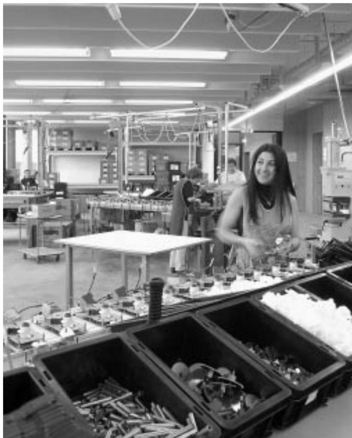
In den Belimo-Werken werden pro Jahr über 2 Millionen Antriebe für Heizungs-, Lüftungs- und Klimaanlage gefertigt.
