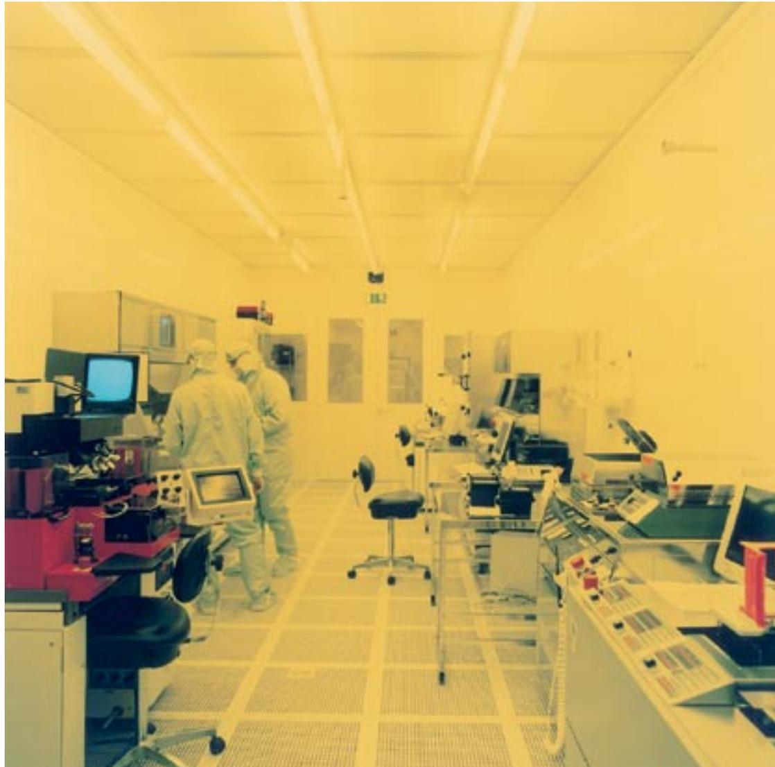
EPF Lausanne: fabrication de micro-systèmes par photolithographie
