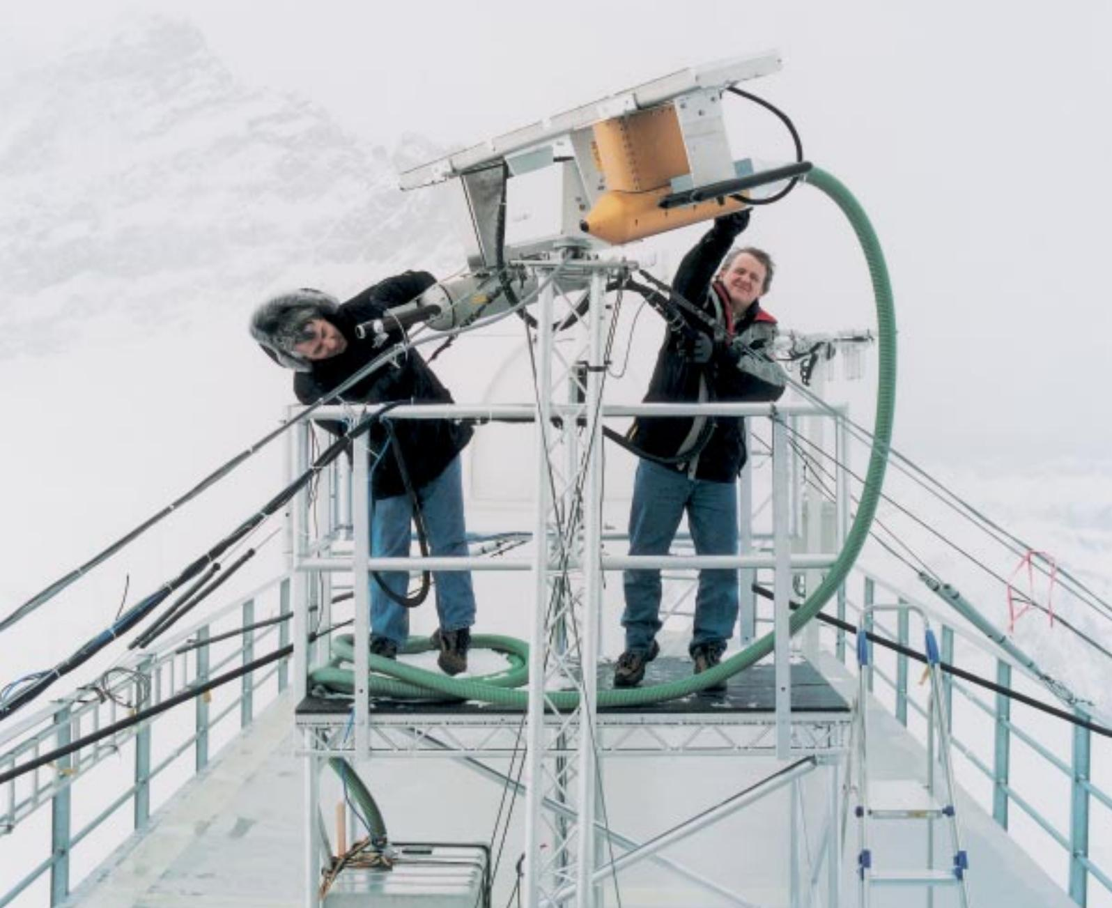
Hochalpine Forschungsstation Jungfrauoch: Hochgeschwindigkeitskamera zur Aufnahme von Schneeflocken
